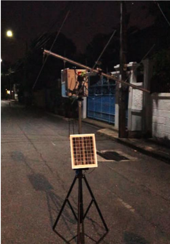
ภาพที่ 8 แขนกลติดตามดาวเทียม พร้อมระบบโซล่าเซลล์
