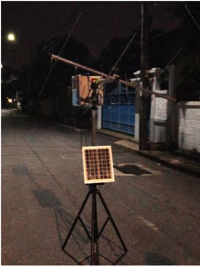
ขณะกำลังรับสัญญาณจาก Mecteor 2-3 Downlink
